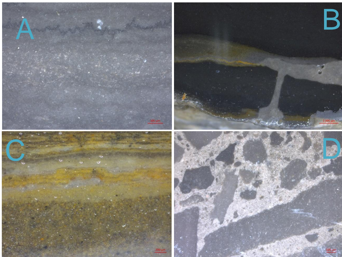
Figura 12. Imagens feitas em lupa binocular das rochas pertencentes à seção PIT: A) estilólito e fábrica nodular B) estrutura de sobrecarga em calcissiltito C) laminação microbial em calcarenito D) brecha intraclástica
